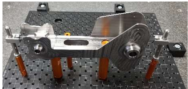
Ferrure de commande de vol en titane
