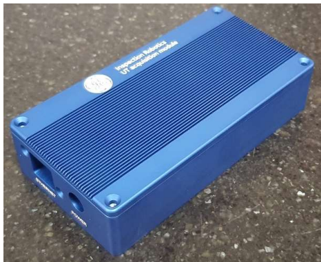
Boîtier en aluminium anodisé et gravé laser pour l'électronique
