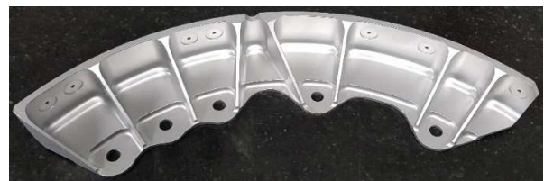
Jonction de cadre de la structure hélicoptère
