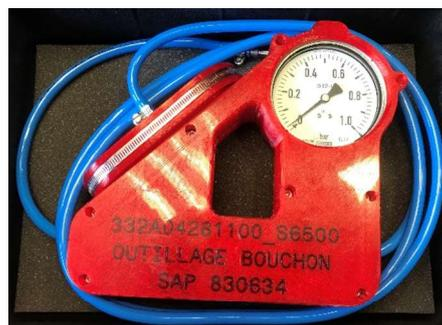
Protection outillage et bouchon d'étanchéité imprimé
